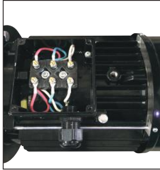
Şekil 2. Yıldız-Üçgen Bağlantı Fig.2. Star-Triangle Connection
