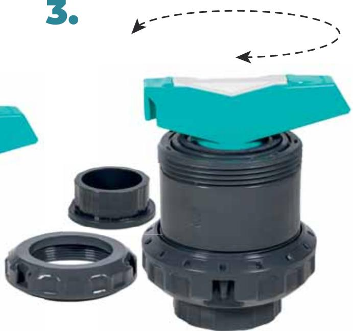
Rakoru çıkarın ve kolu boru bağlantısına yerleştirin, çevirin ve top basıncını ayarlayın.
